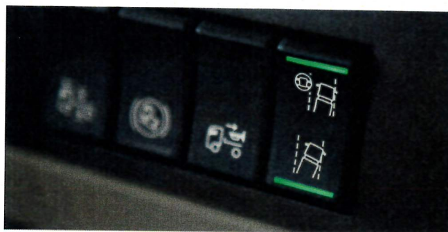
Körfältsassistansens funktioner hanteras med en strömställare på instrumentpanelen.
